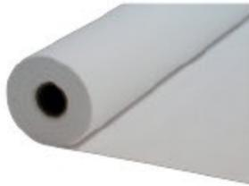
Il geotessuto è uno strato filtrante e drenante, formato generalmente con non tessuti di fibre sintetiche impunturevoli. Proprio per la sua qualità di strato separatore e filtrante il geotessuto è particolarmente impiegato nella realizzazione di pavimentazioni in masselli di calcestruzzo, nella realizzazione di giardini pensili e ogni volta che c'è bisogno di separare due strati.
