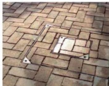
Il chiusino è composto da un telaio in lamiera zincata pressopiegata atto a contenere i masselli autobloccanti. Con vasca interna accessoriata negli angoli da boccole di fissaggio, per favorire una corretta adesione ed un perfetto bloccaggio tra interno e telaio. Questo particolare sistema d'imbullonatura comprime la guarnizione ottenendo così una perfetta ermeticità.
