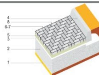
**1 - SOTTOFONDO** - Lo spessore e la composizione del sottofondo sono uguali a quelli normalmente richiesti per la realizzazione di pavimentazioni tradizionali.
